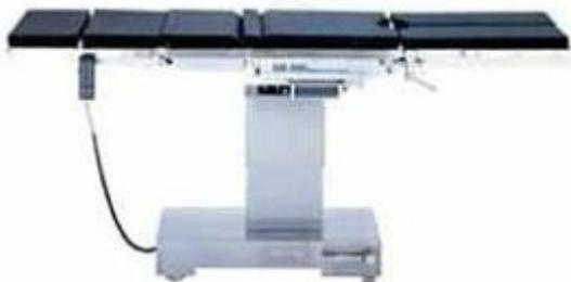
Электрогидравлический многоцелевой операционный стол CHS-2500 для быстрого и точного позиционирования. Работа гидравлического мотора и гидравлических цилиндров обеспечивает плавность движений стола, создающих комфорт пациенту. Высота стола может регулироваться от 680 до 940 мм. Продольное скольжение 280 мм.
