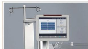
На сенсорной панели ЖК-монитора отображаются и контролируются параметры температуры, влажности, кислорода, SpO2 и веса, также имеет-ся функция тревоги.
